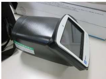
乳幼児も視力検査できる機器 スポットビジョンスクリーナー
